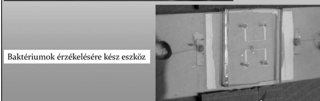
Mikroszkópon lévő, mérésre kész eszköz, melybe a baloldali optikai szálon érkezik a piros mérőfény, ami a jobboldali optikai szálon távozik a fényérzékelőbe. A jobb felső sarokban látható felülnézeti rajz a mikrofluidikai csatorna és a hullámvezetők elhelyezkedését mutatja, ugyanez látható a róla készített alsó fényképen is.
